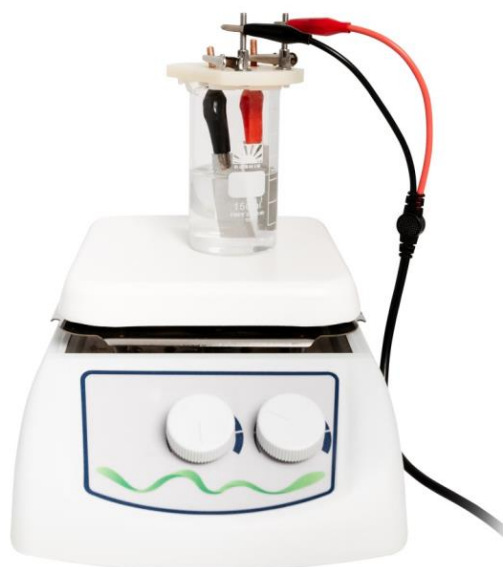
Рис. 19. Фотография установки для получения осадка диоксида свинца.
