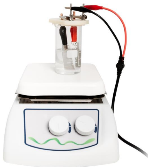
Рис. 10. Фотография установки для определения доли свинца в латуни.
