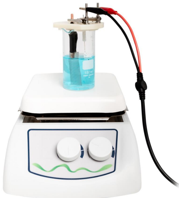
Рис. 8. Фотография установки для определения меди и свинца в латуни.
