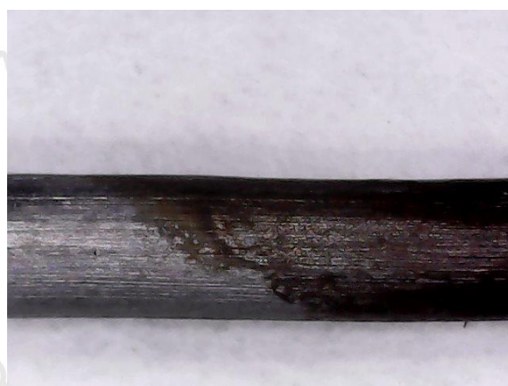
Рис. 16. Окисление свинцового анода в процессе электролиза. Увеличение \times 1000 .
