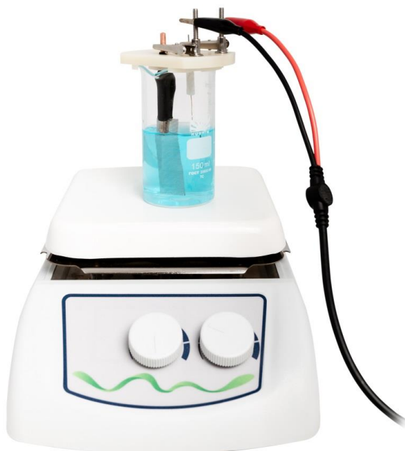
Рис. 6. Фото установки для электрорафинирования меди.
